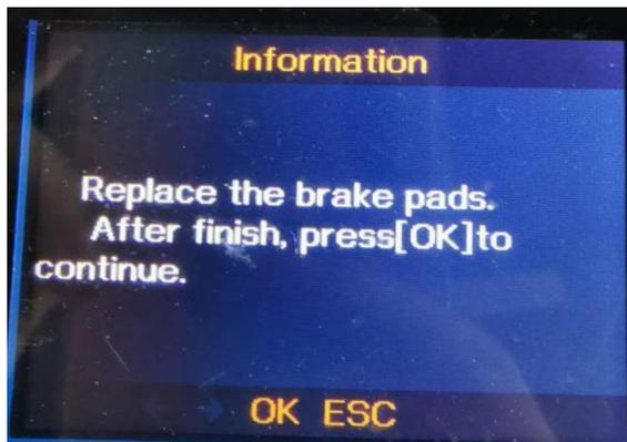
8. Die Funktion zum Bewegen des Vorwärtsbremsmotors wurde ausgeführt und durch Drücken der [OK]-Taste fortgesetzt.
