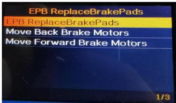
4. Wählen Sie EPB, um die Bremsbeläge zu ersetzen, klicken Sie auf das Menü Um die Bremsbeläge zu ersetzen, klicken Sie auf "OK". Um zu beenden, drücken Sie ESC.
